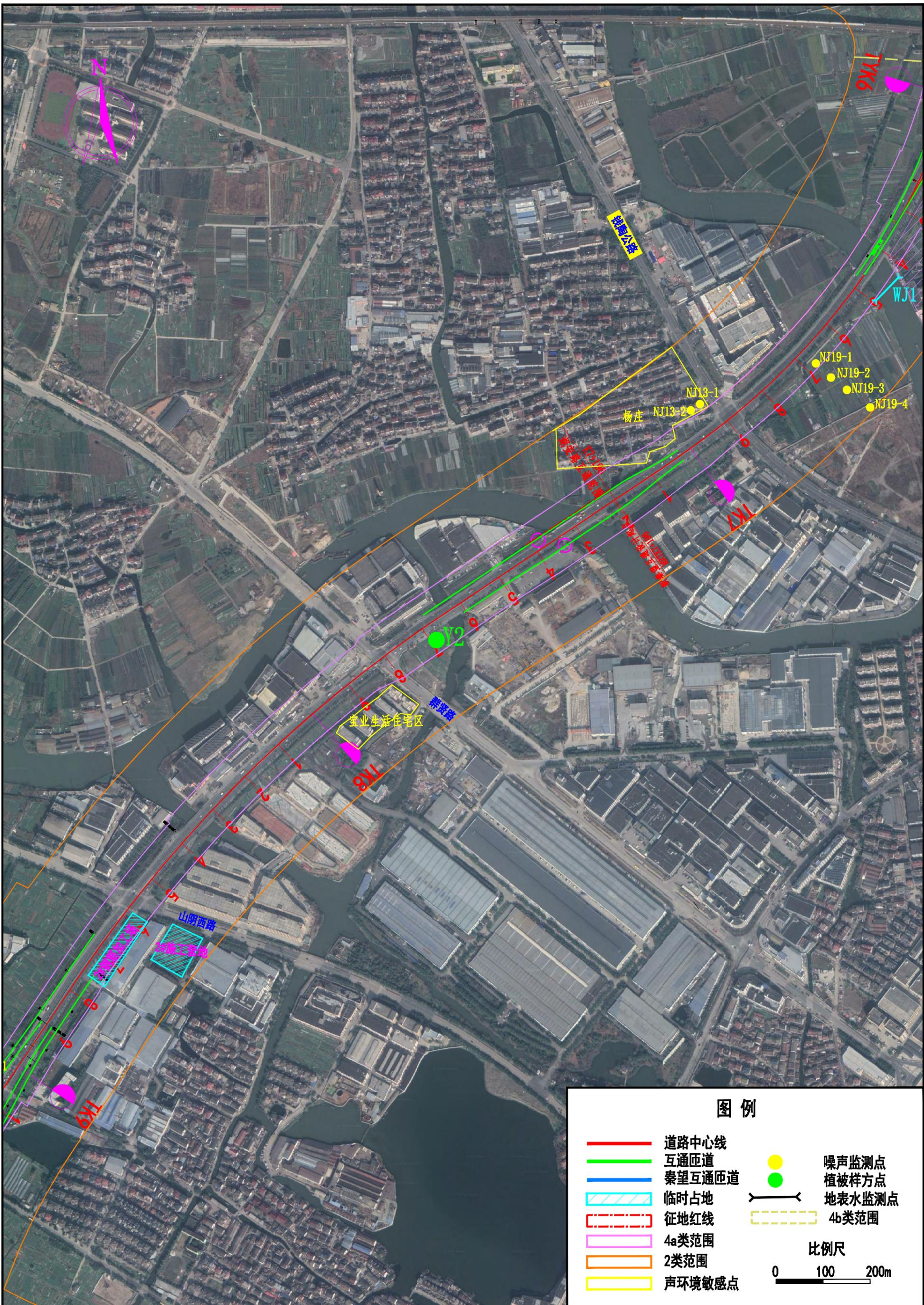
附图三 (3) 拟建道路总平面布置及监测布点图
