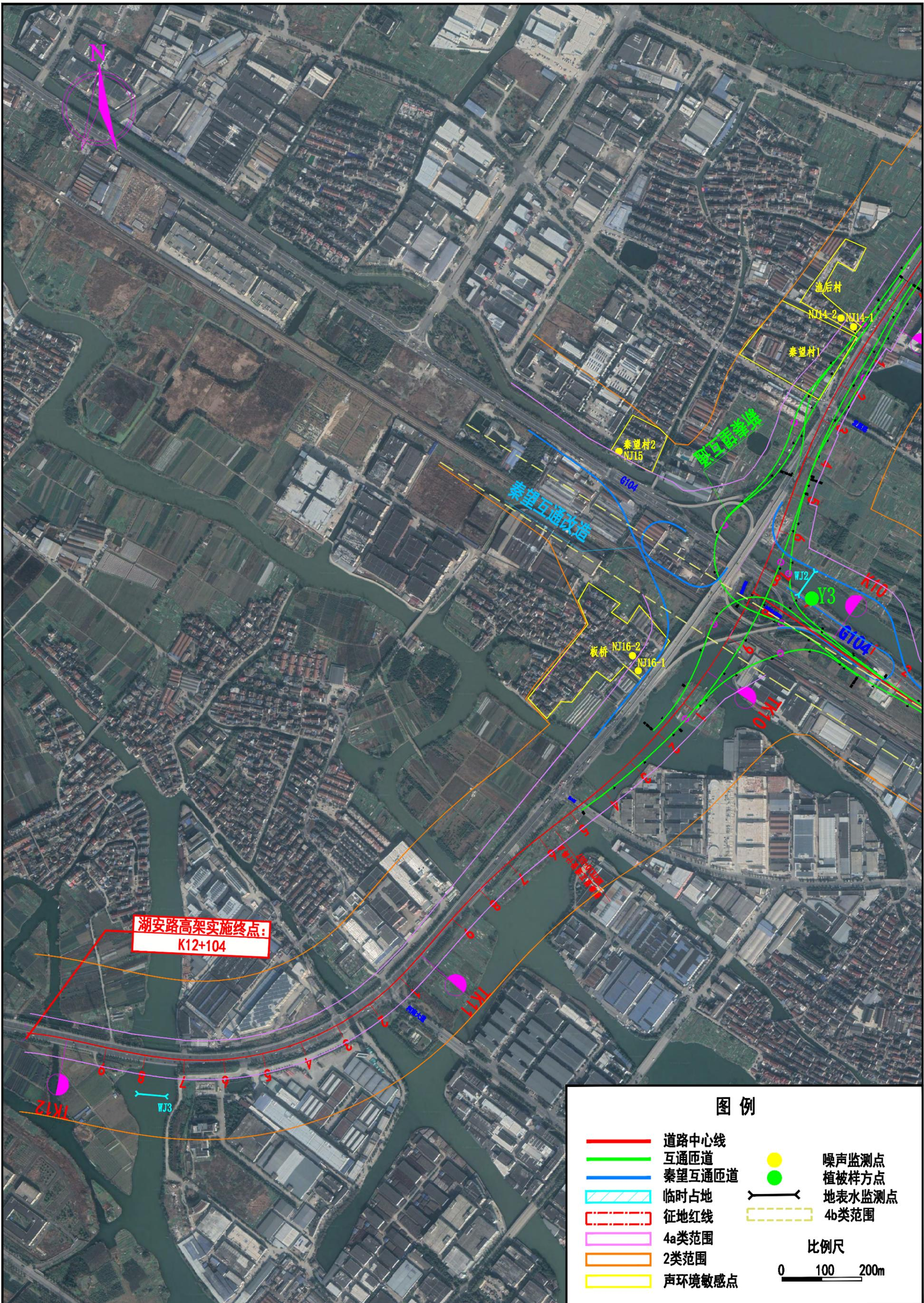
附图三（4） 拟建道路总平面布置及监测布点图
