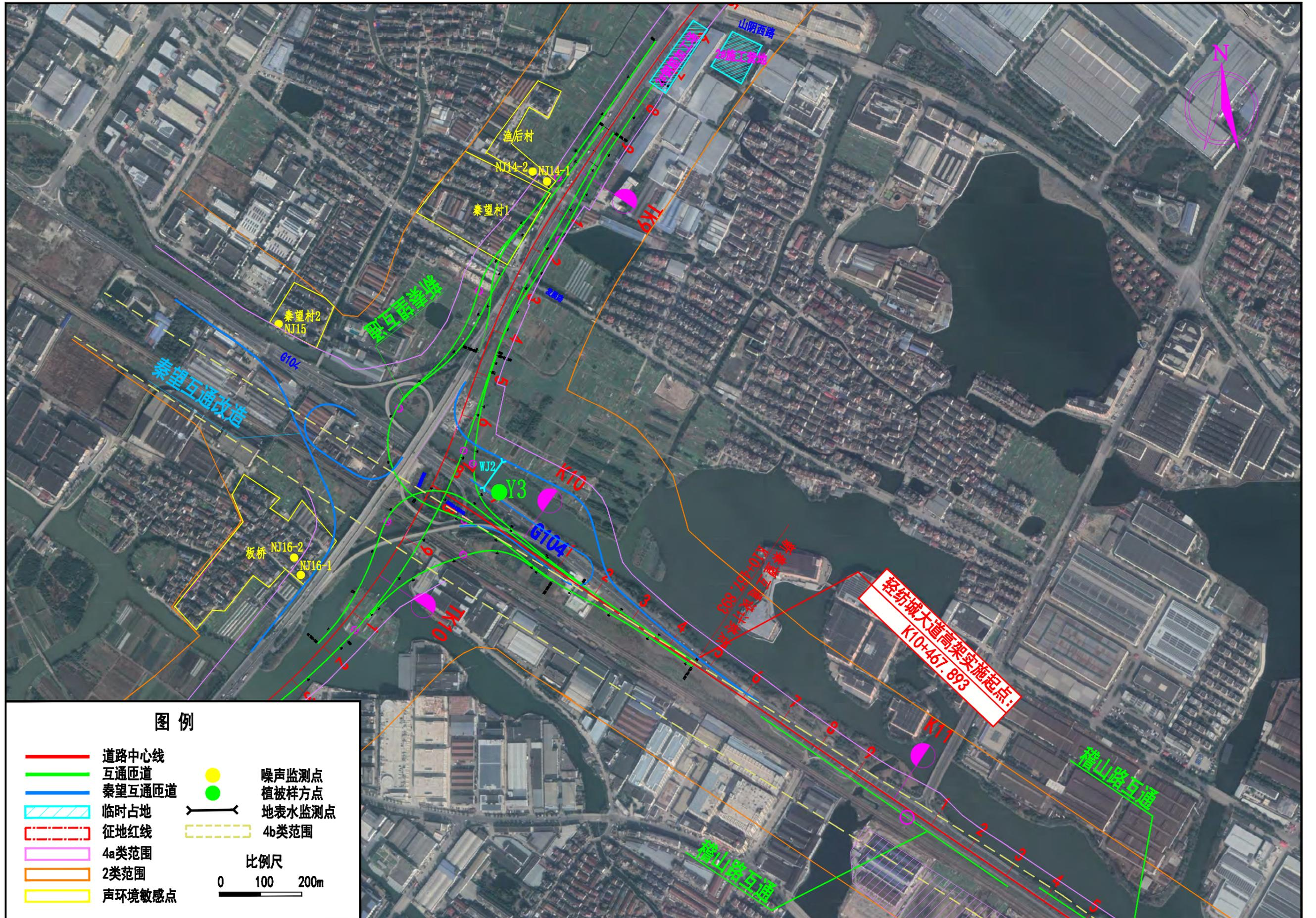
附图三 (5) 拟建道路总平面布置及监测布点图
